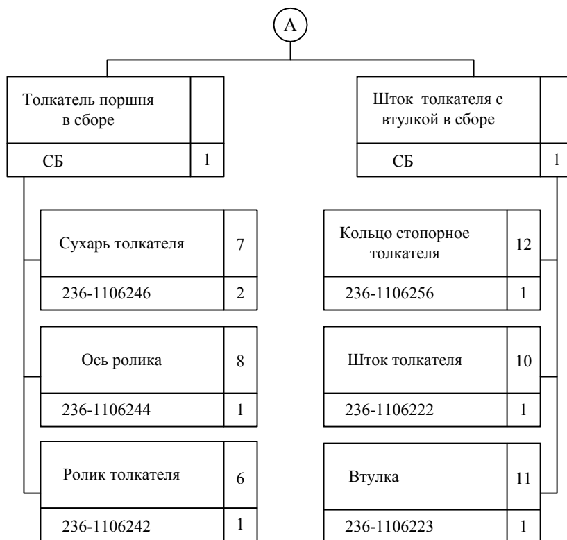
Рис. 6.7. Структурная схема разборки топливоподкачивающего насоса двигателя ЯМЗ-238Н
