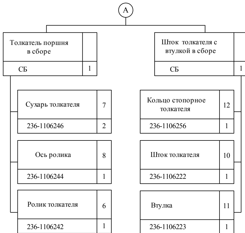
Рис. 6.7. Структурная схема разборки топливоподкачивающего насоса двигателя ЯМЗ-238Н
