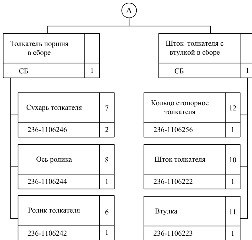
Рис. 6.7. Структурная схема разборки топливоподкачивающего насоса двигателя ЯМЗ-238Н
