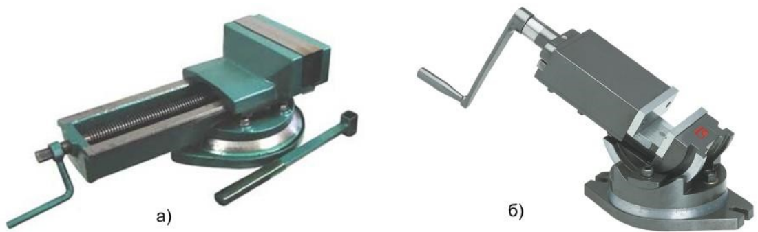
Рис.4 Тиски а) тиски машинные; б) тиски поворотные
