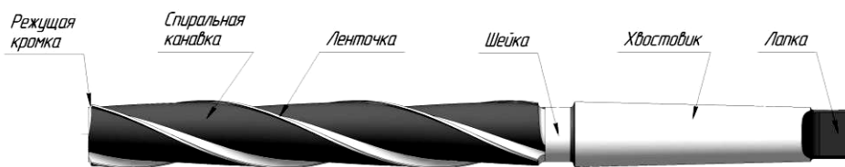
Рис.14 Конструкция хвостового зенкера
