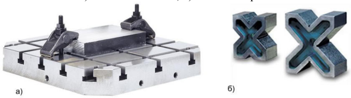
Рис.5 Приспособления а) Закрепление прихватами, б) призмы
