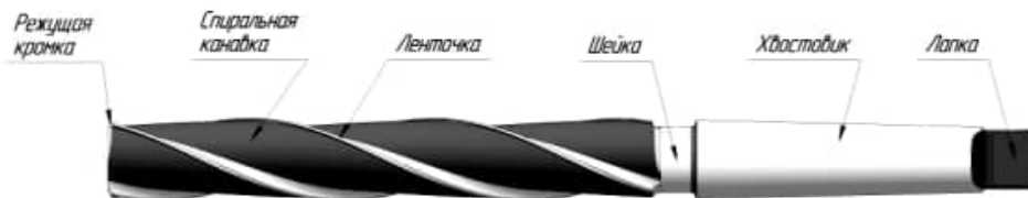
Рис.14 Конструкция хвостового зенкера
