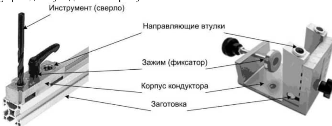
Рис.7 Кондуктор
