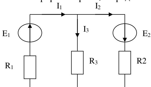
Определить токи в ветвях для выбора сопротивлений по мощности рассеивания и составить баланс мощностей, если  $E_1 = 130$  В;  $E_2 = 85$  В;  $R_1 = R_3 = 20$  Ом;  $R_2 = 40$  Ом;  $r_1 = r_2 = 0$ .
