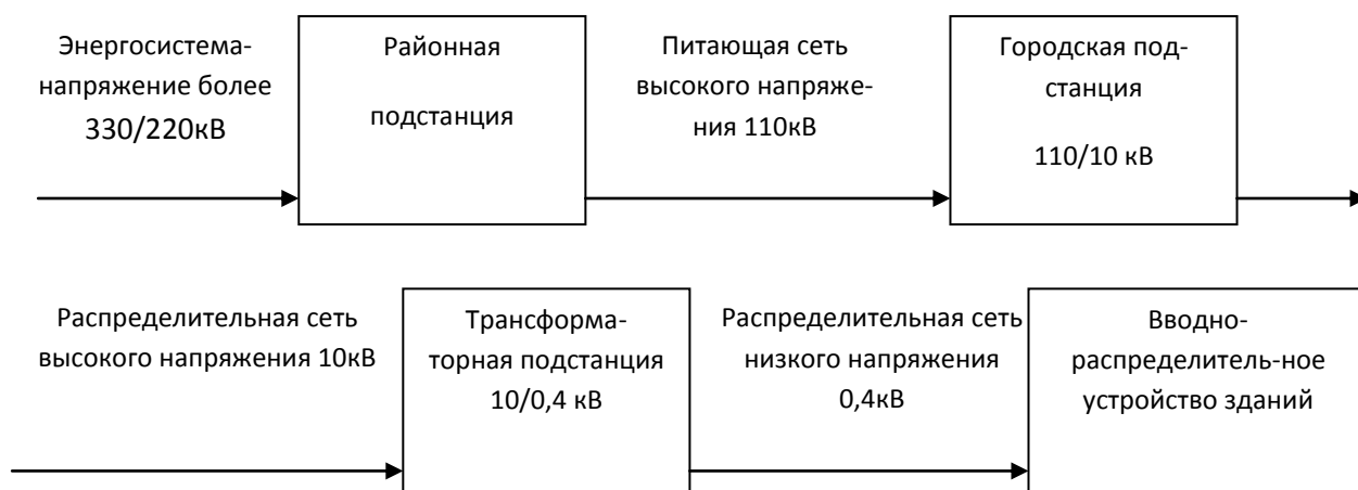
Рис. 9. Система электроснабжения города
