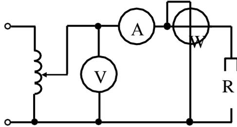
9. Собрать электрическую цепь. Измерить силу тока, напряжение.
