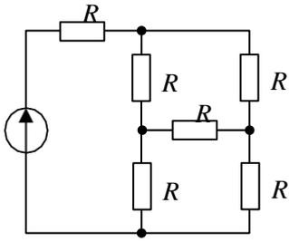
8. Собрать электрическую цепь. Измерить силу тока, напряжение, мощность.
