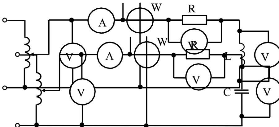
11. Собрать электрическую цепь. Измерить силу тока, напряжение ( $V_1, V_2, V_3$ ), мощность.
