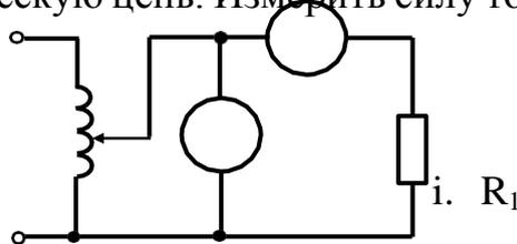
10. Собрать электрическую цепь. Измерить силу тока, напряжение ( $V_1, V_2, V_3$ ), мощность.
