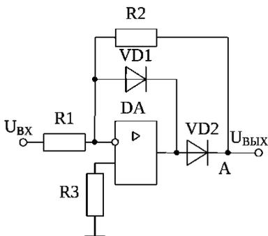
16. Описать работу и выбрать по справочнику тип микросхемы и записать ее параметры.
