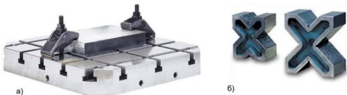
Рис.5 Приспособления а) Закрепление прихватами, б) призмы
