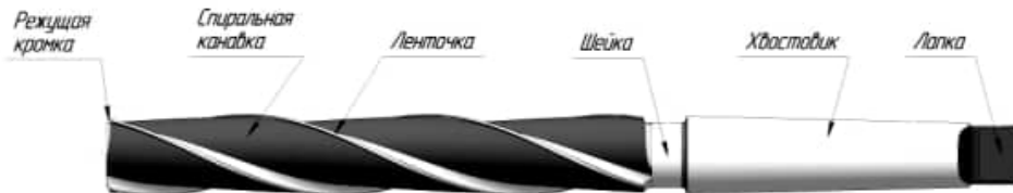
Рис.14 Конструкция хвостового зенкера
