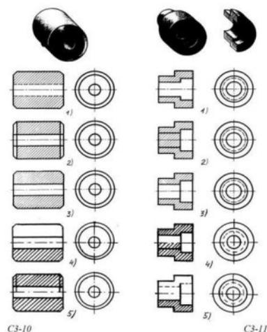
**13 На каком из пяти чертежей выполнен правильно разрез детали, показанной на изображении (рис.С3-11).?**
