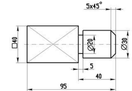
25. Специальный знак  $\varnothing$  используют для нанесения размеров ... (окружностей)
