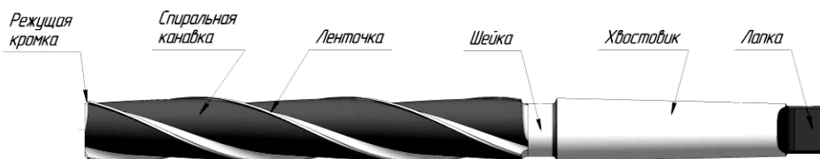
Рис.14 Конструкция хвостового зенкера
