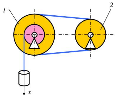
Определите частоту вращения вала электродвигателя при равномерном движении груза, если известно, что таль разгоняет груз в течении первых трех секунд. Радиусы звездочек и барабана:  $r_1 = 0,05\text{ м}$ ;  $R_1 = 100\text{ см}$ ;  $r_2 = 0,12\text{ м}$ .
