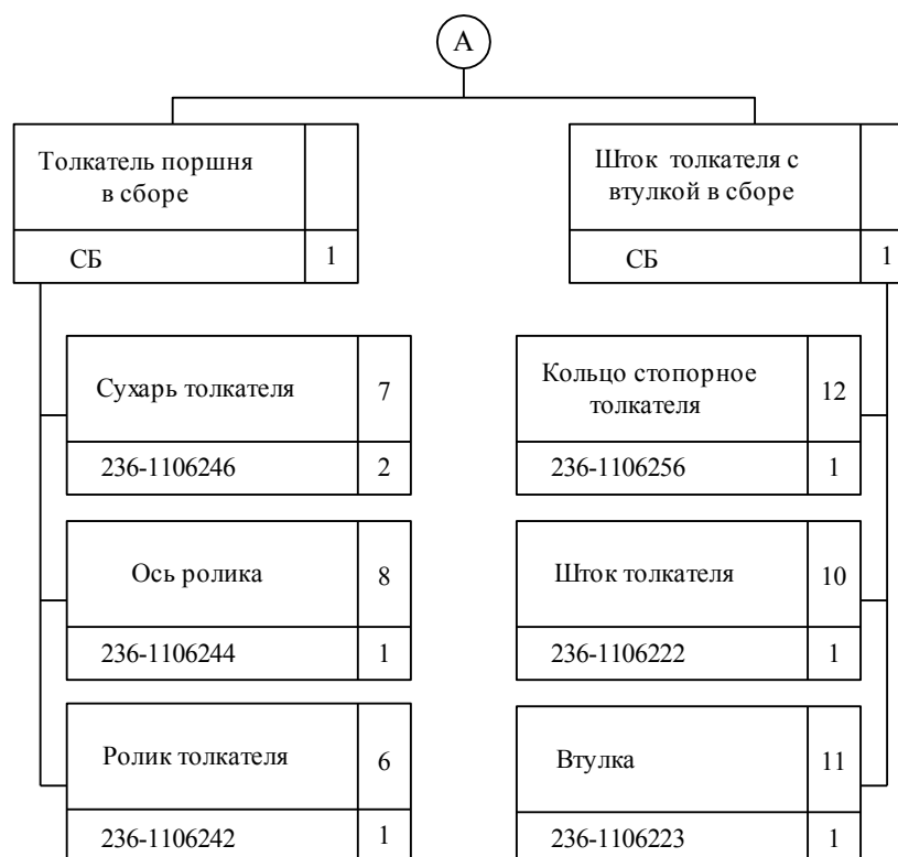
Рис. 6.7. Структурная схема разборки топливopодкачивающего насосa двигателя ЯМЗ-238Н
