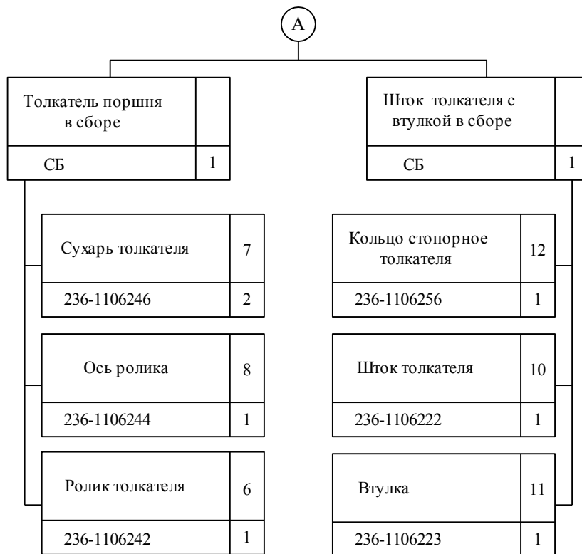
Рис. 6.7. Структурная схема разборки топливоподкачивающего насоса двигателя ЯМЗ-238Н
