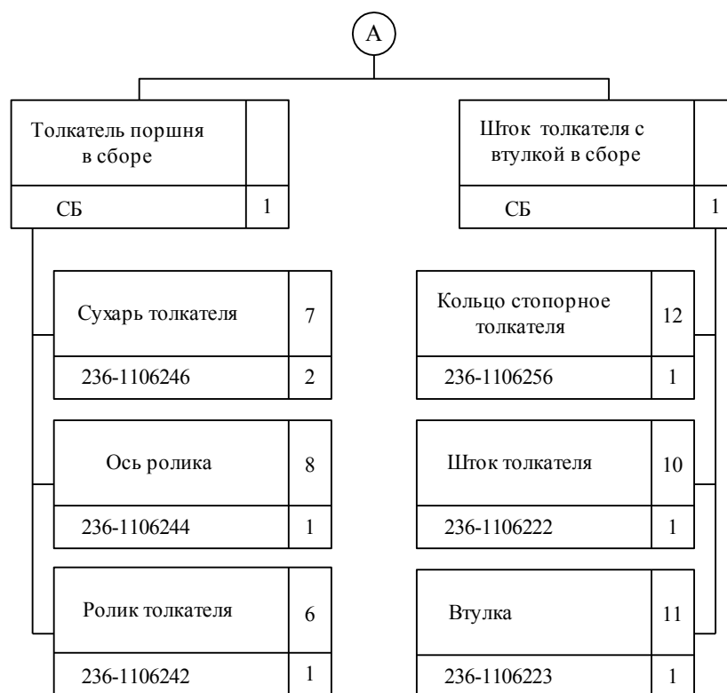
Рис. 6.7. Структурная схема разборки топливopодкачивающего насоса двигателя ЯМЗ-238Н
