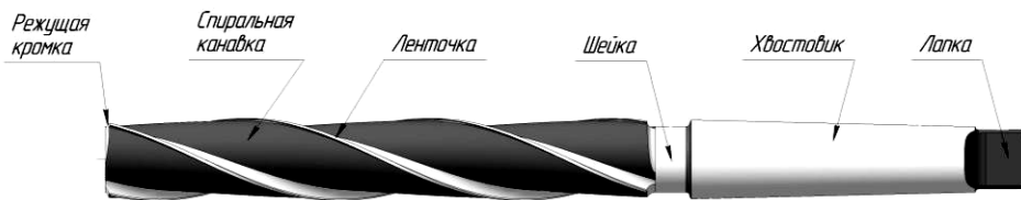
Рис.14 Конструкция хвостового зенкера
